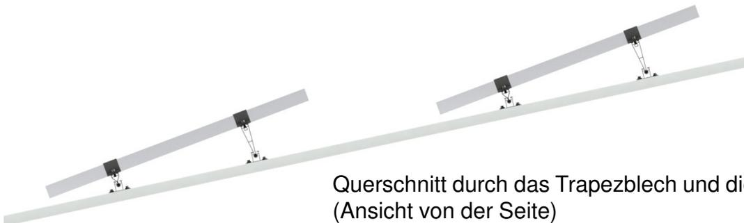
Querschnitt durch das Trapezblech und die PV-Anlage
